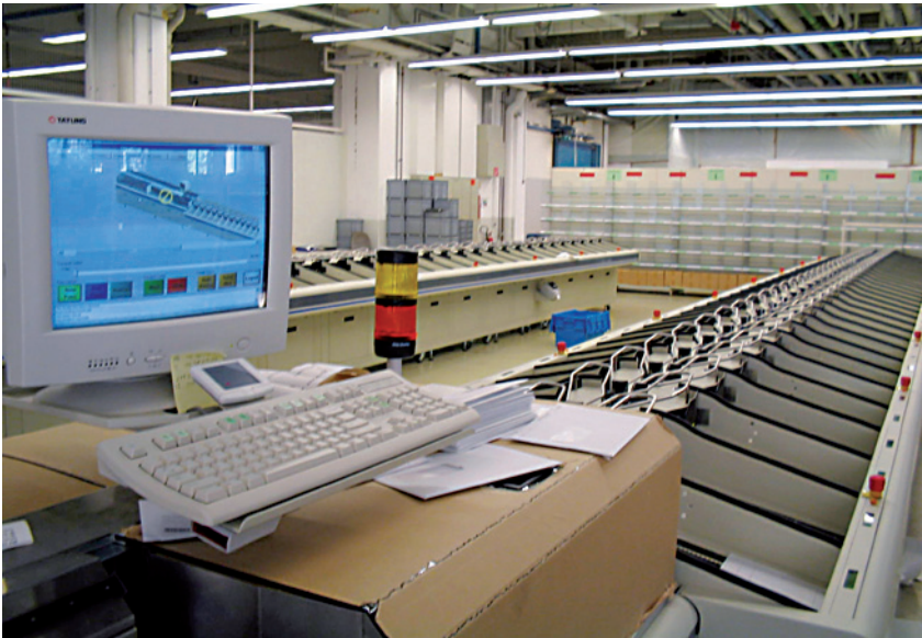
Bei der LMF sortieren zwei Olympus II Linear Sorter von Pitney Bowes jeweils bis zu 24.000 Briefe pro Stunde
