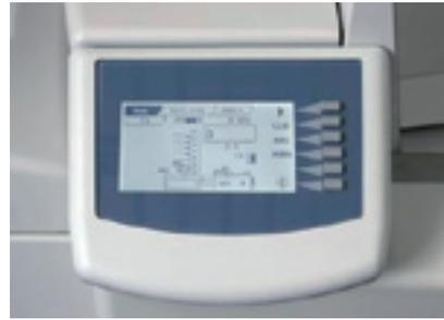
**Das Bedienpanel:** Die Steuerung des Systems erfolgt über ein Bedienerpanel mit großem Display und übersichtlicher Menüführung. Mit der Schnellstart-Funktion ist das System sofort betriebsbereit. Alternativ erstellen Sie eigene Jobs und speichern diese ab.
