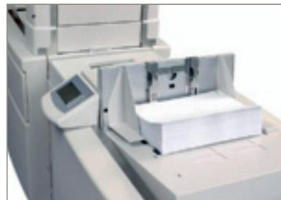
**Schneller Jobwechsel:** Mit dem Wechsel eines Jobs wird – neben anderen Parametern – auch automatisch die Einstellung der Transporteinrichtung für das Kuvertiergut justiert. Dadurch entfallen entsprechende manuelle Einstellungen.
